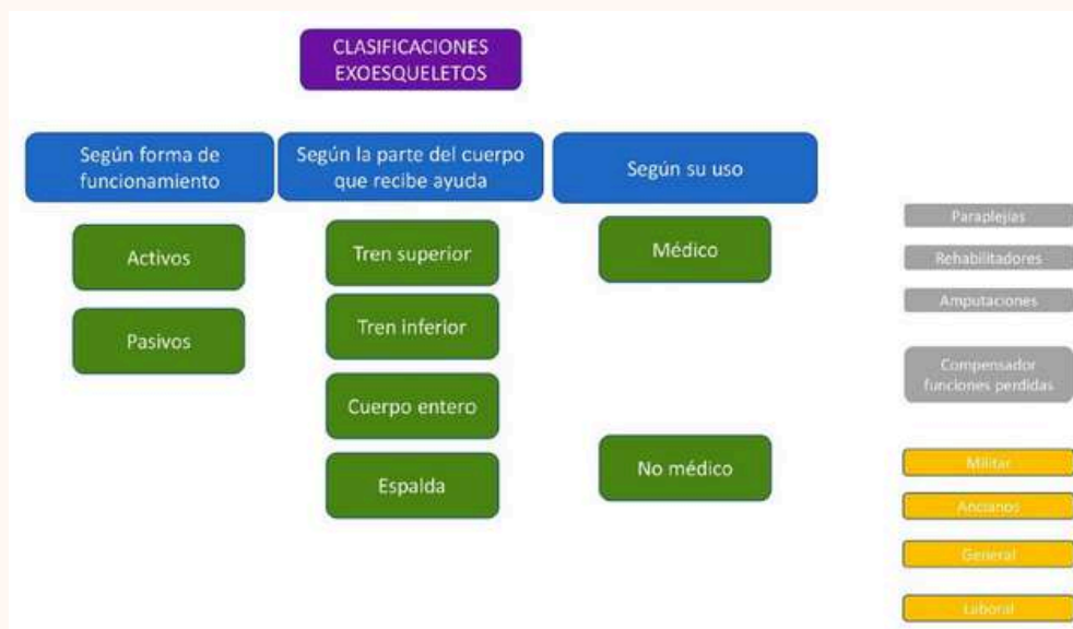
Fig. 1. Clasificación de exoesqueletos (Fuente: INSST, NTP 1162, 2021)
